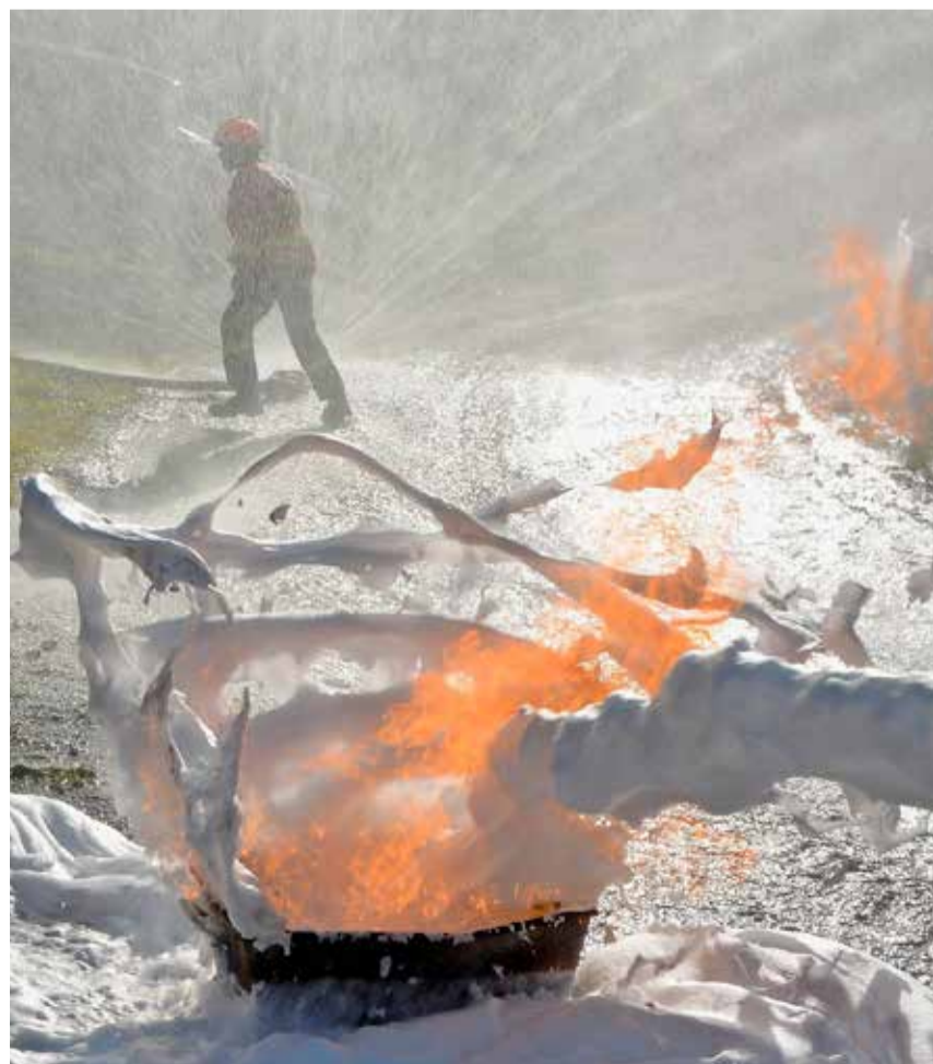
Mit Wasser und Schaum: Ein Wasservorhang schützt das Fahrzeug im Hintergrund, während dem Feuer im Vordergrund der Garas gemacht wird.
